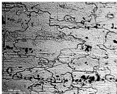
Рис. 2– Микроструктура алюминиевого сплава В95 в состоянии проката (исходный образец), полученная на оптическом микроскопе МИМ-8М, увеличение ×225
