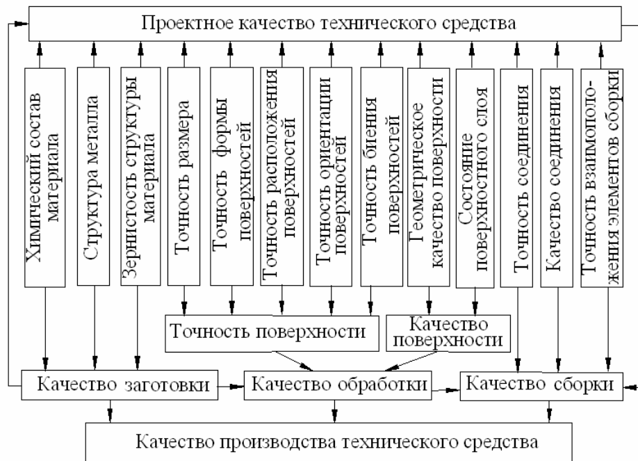
Рис. 1. Схема формирования качества технических средств
