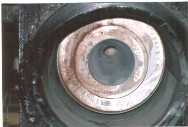
Рис. 2. Комель лопасти воздушного винта с поврежденной рабочей поверхностью
