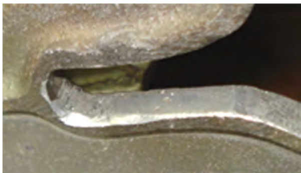
Рис. 6. Рабочая поверхность корпуса замка створки шасси самолета Ан-24
