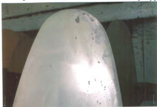
Рис. 1. Лопасть воздушного винта авиадвигателя АИ-24 с поврежденной поверхностью
