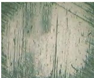
Рис. 5. Поверхность стали 45 со свинцовым покрытием
