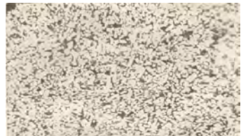
Рис. 3. Мікроструктура сплаву КХНФ-15, \times 340
