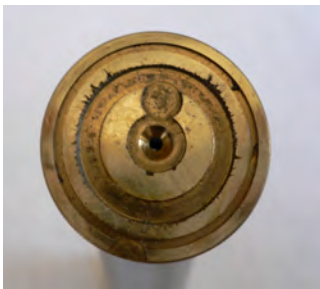
Рис. 1. Руйнування повзуна плунжера в результаті кавітаційного вимивання
