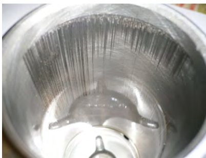
Рис. 5. Риски та задири на внутрішній поверхні циліндра сервопоршня в наслідок гідроабразивного зношування
