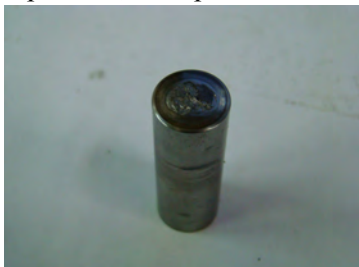
Рис. 2. Руйнування плунжера в результаті втомного розтріскування
