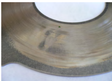
Рис. 4. Пятно контакту на сталевій опорній пластині як результат фретинг-корозії в парі з похилою чавунною шайбою
