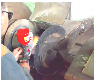
Рис. 5. Процес наплення порошку бабіту газополуменевим методом
