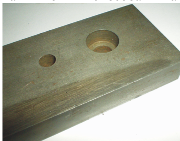
Рис. 2. Зразок з частковим загартуванням
