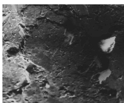
Рис. 2. Поверхность трения разработанного сплава. Условия испытания: v = 1 м/с, P_{\text{уд}} = 1 МПа, t = 20 °С, контртело одноименная пара; a - \times 1500 ; б - \times 4500
