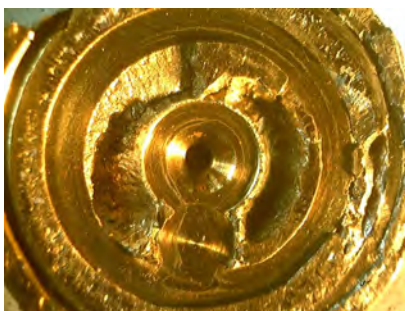
Рис. 1. Кавитационное вымывание ползуна
