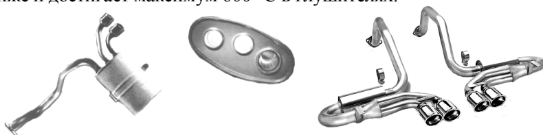
Рис. 4. Титановые детали выхлопной системы Chevrolet Corvette Z06
