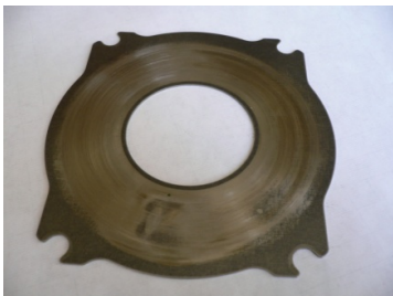
Рис. 2. Виникнення розтріскування в області пята контакта сталій опірній пластині в результаті фретинг-корозії в парі з похилою чавуною шайбою
