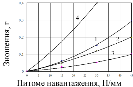
Рис. 5. Вплив умов випробувань на величину зношення хромованої (1), хромотитанованої (2), і нікельхромованої (3) сталі 12Х18Н10Т (4): P = 15\text{Н/мм} , \tau = 20\text{ хв}
