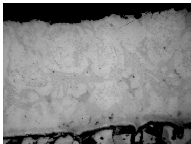
Рис. 3. Структура оплавленого КЕП після ТО 1250°C, × 200
