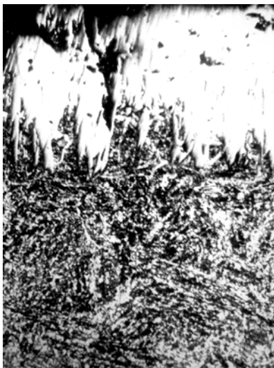
Рис. 5. Борований шар поверхні сталі 34Х3МА у складі шихти №1 ( \times 2000 ): a – поперечний вигляд захисного покриття в шихті 1 після буровання; б – вид зверху покриття після буровання в шихті 1
