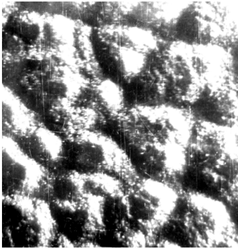
Рис.7. Механізм зношування взірців з зміцненою поверхнею буровання в шихті 1: a – перед початком випробувань; б – після 30% ресурсу випробувань; в – після 80% ресурсу випробувань
