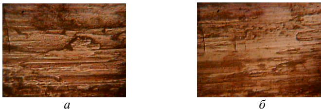
Рис. 1. Мікроструктури поверхонь тертя, \times 500 : a – термічна обробка + ГТЦ ІА (режим 5); б – термічна обробка + ГТЦ ІА (режим 9)
