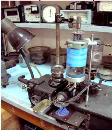
Рис. 3. Внешний вид и схема установки на абразивное изнашивание: 1 – бункер для отходов абразива; 2 – образец; 3 – резиновый ролик; 4 – головка для рулона; 5 – бункер для свободного абразива; 6 – рычаг для регулирования скорости подачи абразива; 7 – свободный абразив; 8 – желоб для подачи абразива; 9 – рычаг для регулирования нажима; 10 – груз
