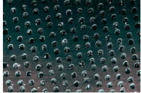
Рис. 4. Мікроструктура поверхні після лазерного текстурування: діаметр заглибини – 100 мкм, глибина – 10 мкм, щільність заглибин – 20%
