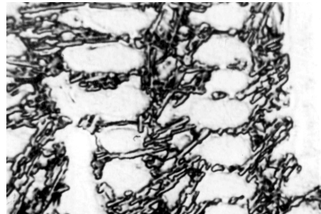
Рис. 2. Мікроструктура легованого евтектичного сплаву: еутектичного складу (а), доевтектичного складу (б), \times 500
