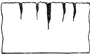
Рис. 1. Характер зарождения и развития трещин по сечению обода тормозного шкива
