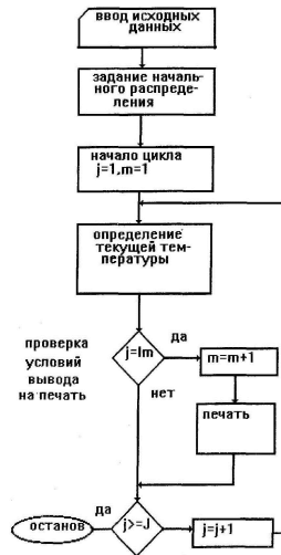
Рис. 2. Алгоритм расчета поверхностных температур металлополимерных пар трения тормозного устройства
