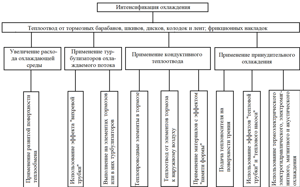
Рис. 8. Классификация способов и конструктивных решений интенсификации теплообмена во фрикционных узлах тормозных устройств
