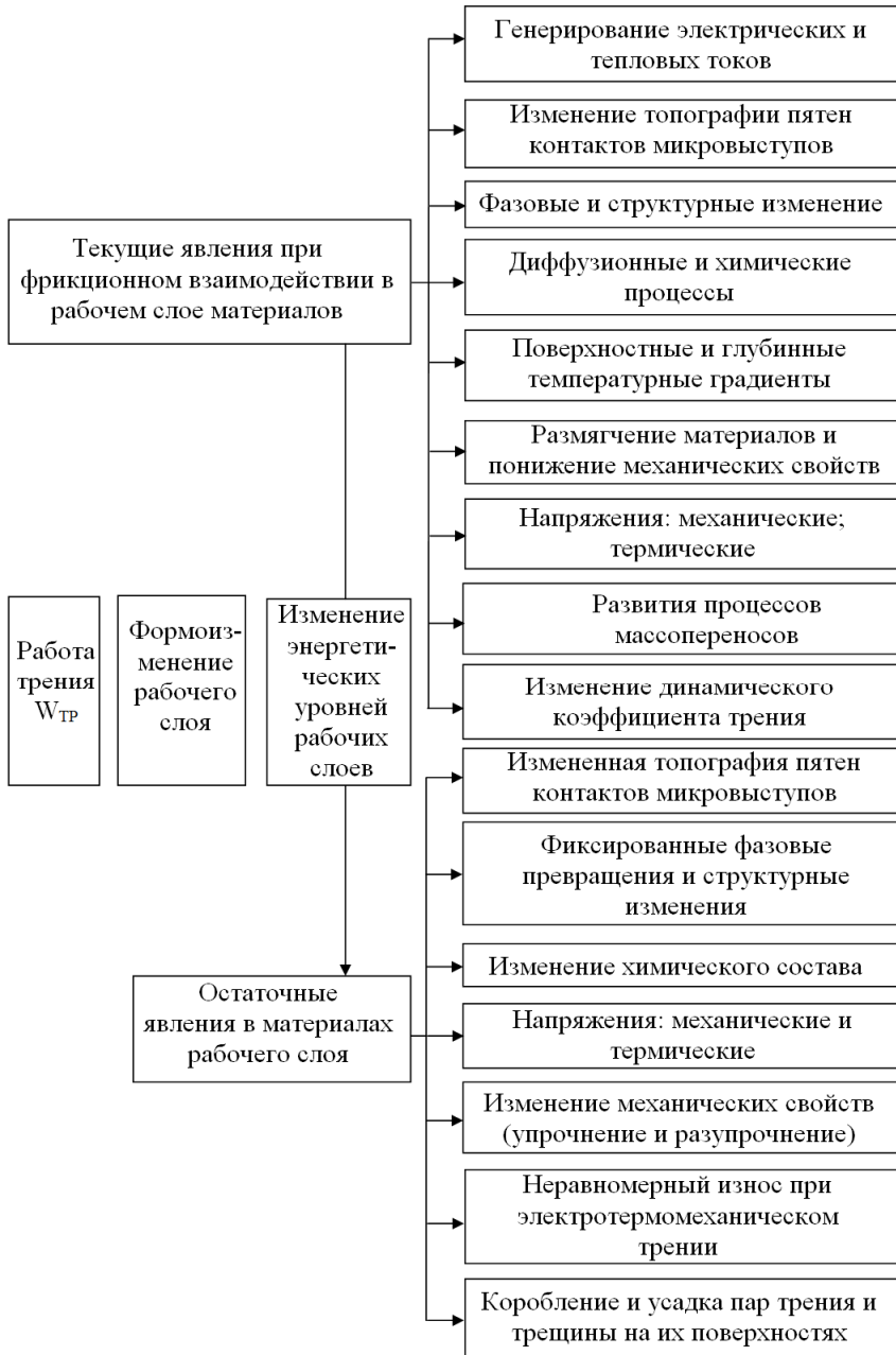
Рис. 1. Структурная схема воздействия совокупности полей на изменение энергетических уровней рабочих слоев фрикционных узлов при электротермомеханическом трении
