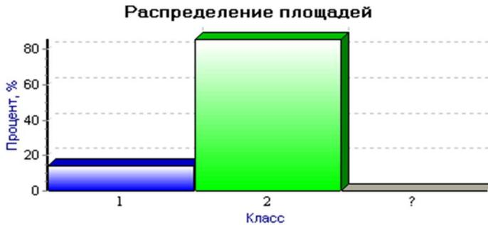
Рис. 2. Результаты количественного стереологического анализа пористости поверхности, восстановленной газотермическими покрытиями: ■ - класс 1, поры 14,39 % площади; ■ - класс 2, основа 89,61 % площади; ■ - прочие 0 % площади
