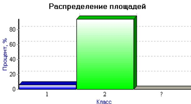
Рис.4. Результаты количественного стереологического анализа пористости восстановленной газотермическими покрытиями поверхности после электроконтактной обработки: ■ - класс 1, поры 3,13 % площади; ■ - класс 2, основа 96,87 % площади; ■ - прочее 0 % площади
