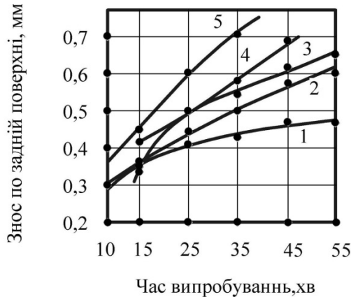
Рис. 4. Кінетика зносу твердосплавної пластини T15K6 з покриттями: 1-(Ti, V, Cr) C; 2-(Ti, Cr) C; 3-TiC; 4- VC, Cr7C3; 5-без покриття; точіння сталі X12M; V = 3,3 м/с; S = 0,036 мм/об; \tau = 1,0 мм
