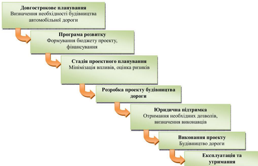
Рис. Життєвий цикл будівництва автомобільної дороги як інфраструктурного проекту
