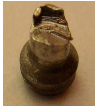
Рис. 7. Усталостное разрушение шейки штока
