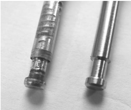
Рис. 6. Износ поверхностей штока в процессе отработки ресурса
