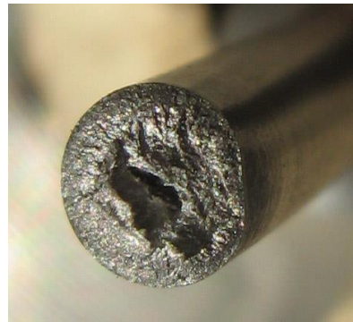
Рис. 10. Усталостные изломы стержневых элементов ЭМК с приводом типа ДТВ: а – материал VT5-1; б – материал АК4-1; в – материал VT1-0
