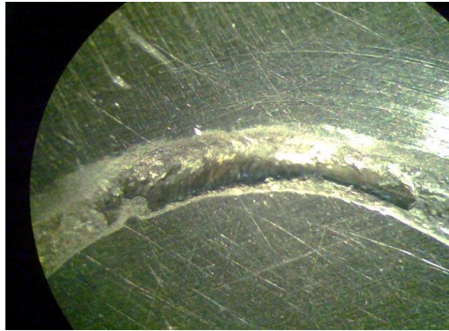
Рис. 5. Дорожка трения на сплаве ВТ6 после испытаний на фреттинг-коррозию
