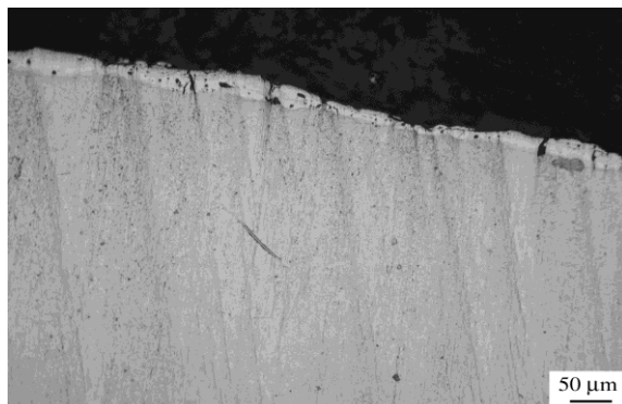
Рис. 1. Структура сплава ВТ6 с электроискровым покрытием молибденом
