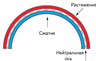
Рис. 2. Деформация ГПП при изгибе
