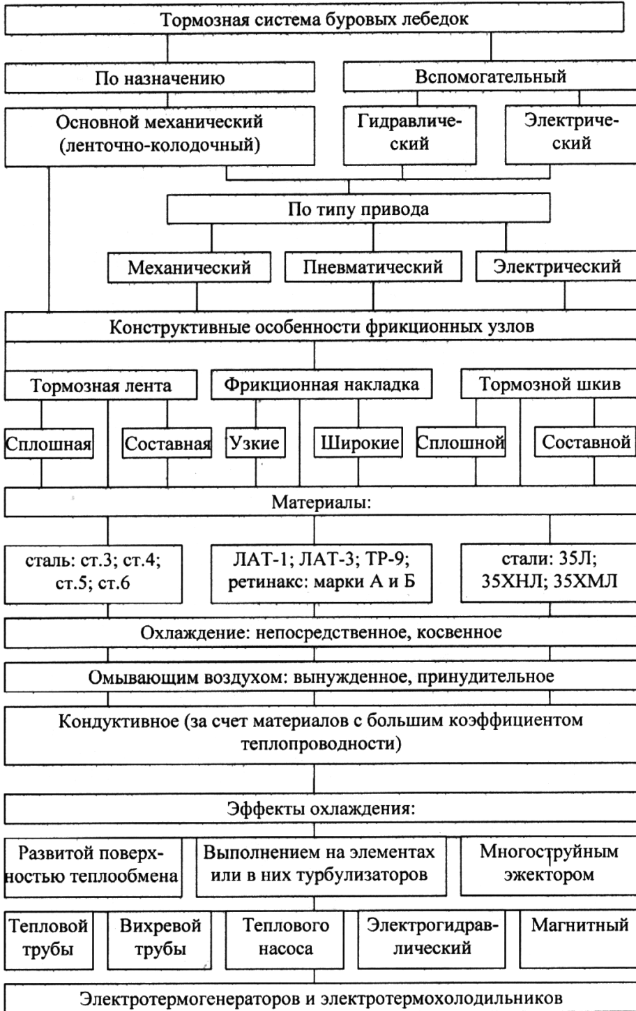
Рис. 1. Особенности элементов фрикционных узлов и методы снижения их энергонагруженности в ленточно-колодочных тормозах буровых лебедок
