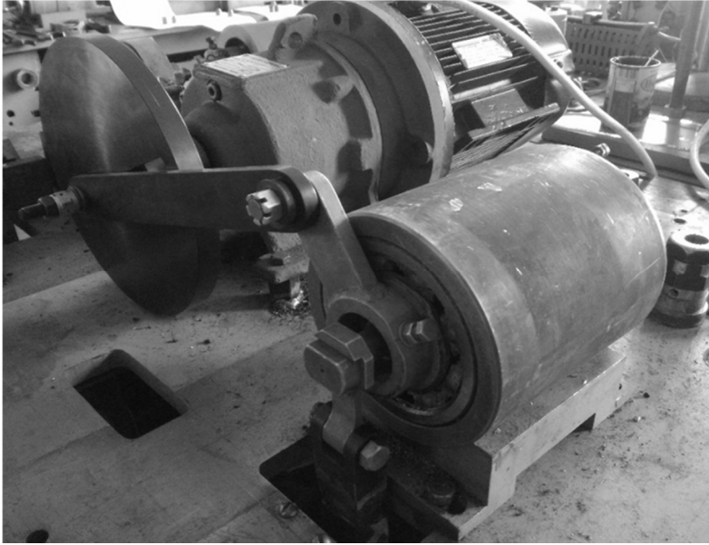
Рис. 4. Установка для випробування на зносостійкість підшипників діаметром від 12 до 30 мм
