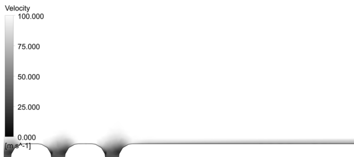
Рис. 4. Пограничний шар на пластині з використанням відсмоктування (канали з профільованими вхідними кромками)
