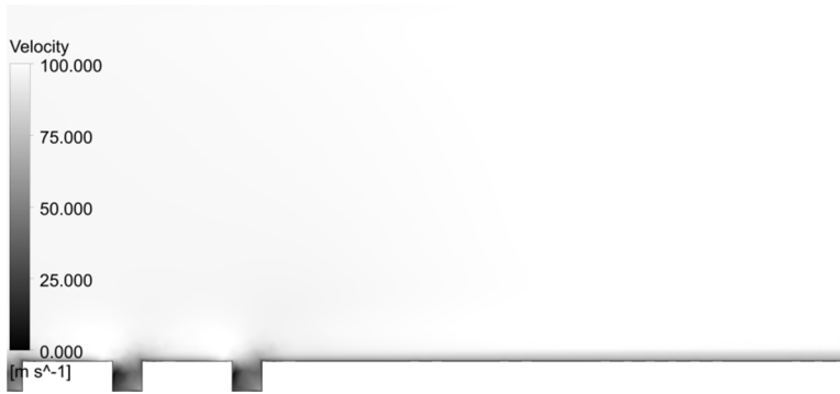
Рис. 3. Пограничний шар на пластині з використанням відсмоктування (канали з прямокутними вхідними кромками)
