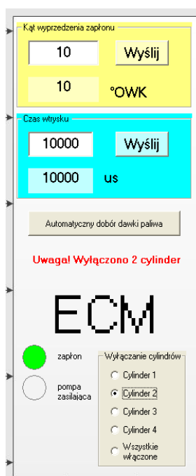
Rys. 6. Okno dialogowe programu, stan sterownika – praca w trybie „Wyłączanie cylindrów”- aktywny przycisk wyłączenia zapłonu i wtryskiwacza w cylindrze nr.2, wyświetlony komunikat „Uwaga! Wyłączono 2 cylinder”, zapłon włączony, pompa zasilania wyłączona
