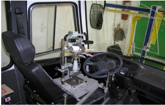
б) процес випробування Рис.2 Проведення випробувань з визначення параметрів передньої оглядовості з РМВ
