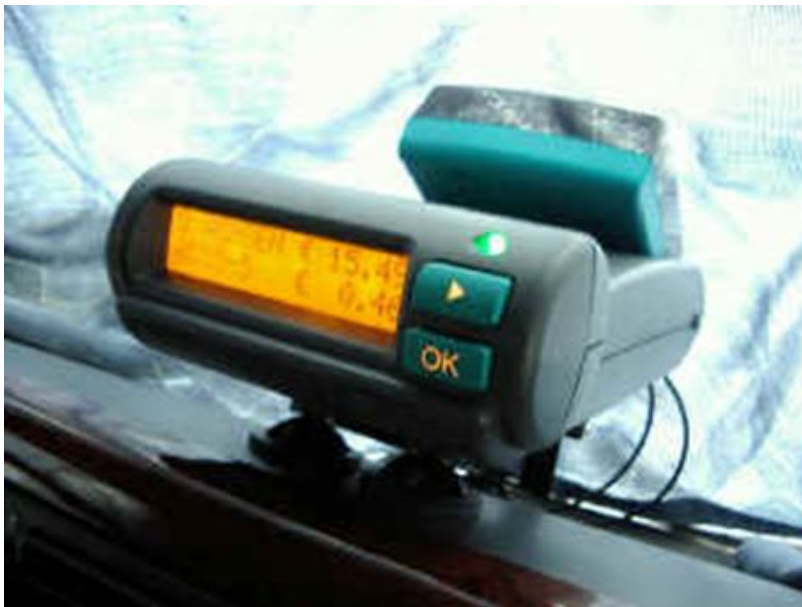
Rys.4. Przykład transpondera wykorzystywanego przez użytkowników systemu Toll collect w Niemczech [29]
