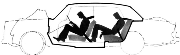
Схема деформування автомобіля з використанням принципів пасивної безпеки
