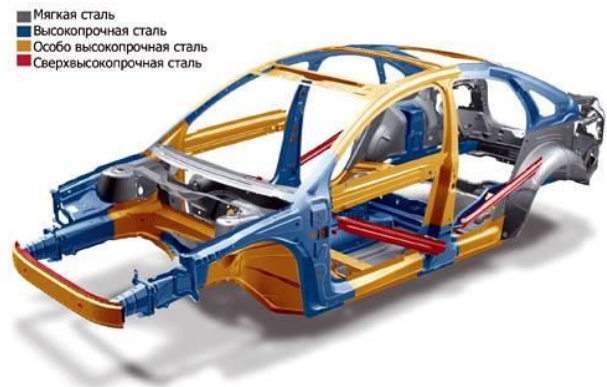
Елементи конструкції травмо- безпечного кузова
