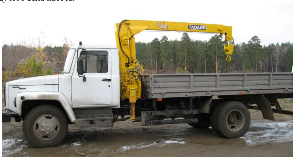
Рис. 2.1. Загальний вигляд автомобіля-самонавантажувача із консольним краном TADANO на шасі ГАЗ-3309.
