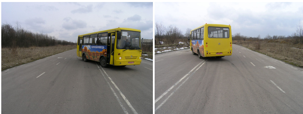
Рис. 2. Результат гальмових випробувань автобуса А074 з нерозрізною поздовжньою тягою
