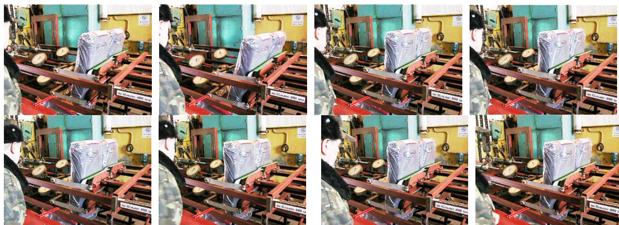
Рис. 3. Загальний вигляд сидіння, встановленого на випробувальному стенді та кінограма процесу навантаження сидіння
