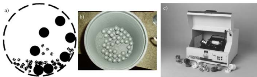
Рис.4. а) – Схематичне зображення кулькового млина; б) – кульковий млин із завантаженим матеріалом для подрібнення; в) – зовнішній вигляд лабораторного кулькового млина [24]
