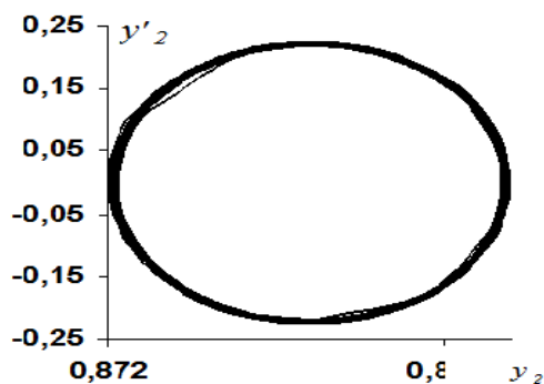
Рис. 20. Фазовий портрет коливань ТН для значень пружного та в'язкого опору C_{13}=C_{32}=2 \cdot 10^6 , \gamma_{13}=\gamma_{23}=5 \cdot 10^3
