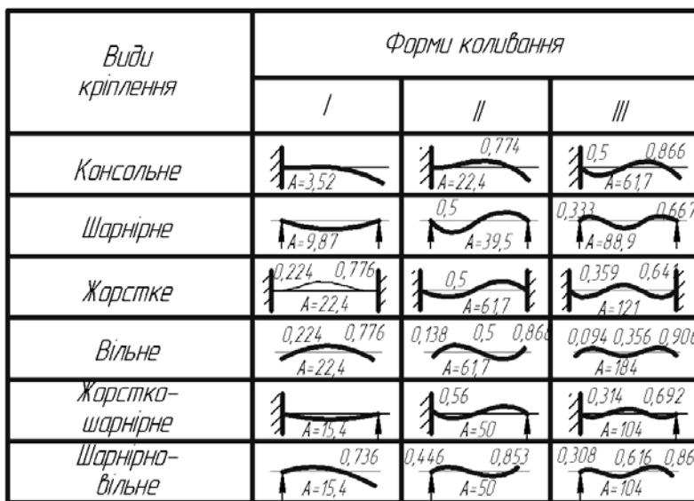
Рис. 3. Форма згинальних коливань при різних видах закріплення елементів
