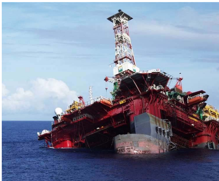
Рис. 3. Крен плавучої напівзануреної бурильної платформи Petrobras P-36, 15.03.2001 [7]
