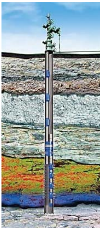
Рис. 7. Схема системи видалення рідини із газових свердловин Perflift з розташованими під експлуатаційним пакером газліфтними клапанами для піднімання рідини з нижнього продуктивного інтервалу
