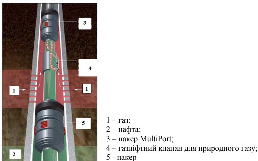
Рис. 1. Схема безкомпресорного газліфта
