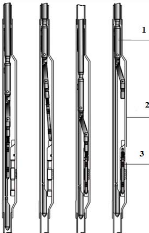
1 – консольний відхилювач; 2 – камера з боковим карманом; 3 – газліфтний клапан Рис. 4. Схема знімних газліфтних клапанів
