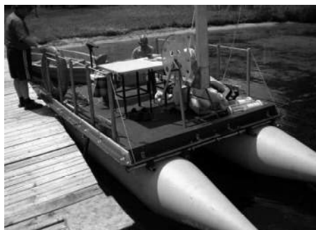
Рис. 5. Плавуча екологічна лабораторія на базі катамарана «Аргонавт – 6»
