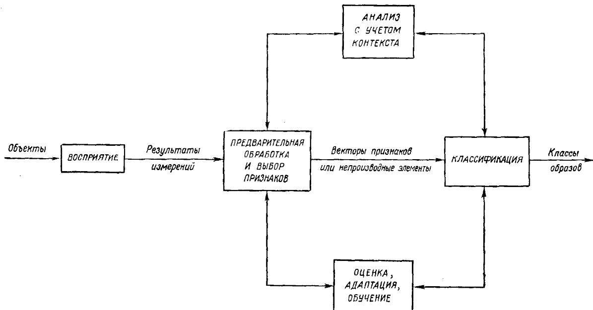
Рис. II-3. Схема адаптивної системи розпізнання образів (за Д. Ту та Р. Гонсалесом), що дозволяє паралельно виділяти класи на основі даної виборки та відносити об'єкти до них.
