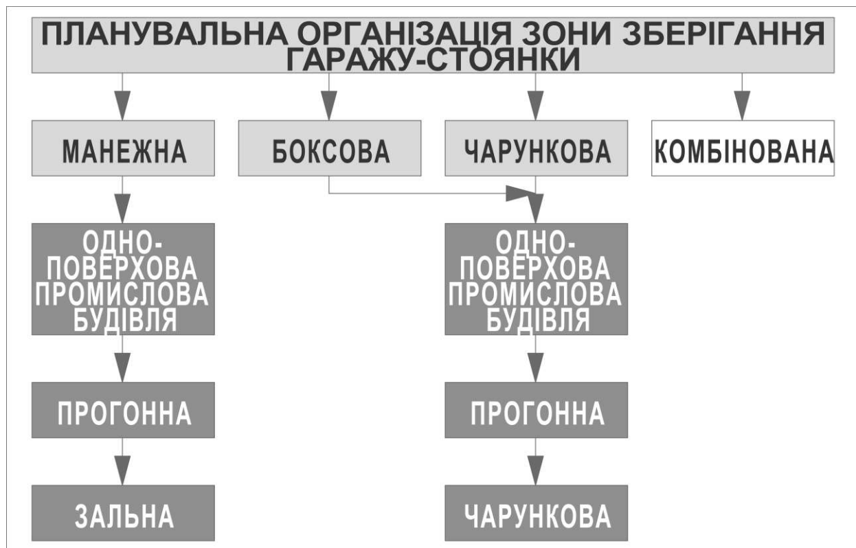
Рис.3. Схема-підбір промислових корпусів для перепрофілювання у гаражі-стоянки за планувальною організацією зберігання гаражу-стоянки
