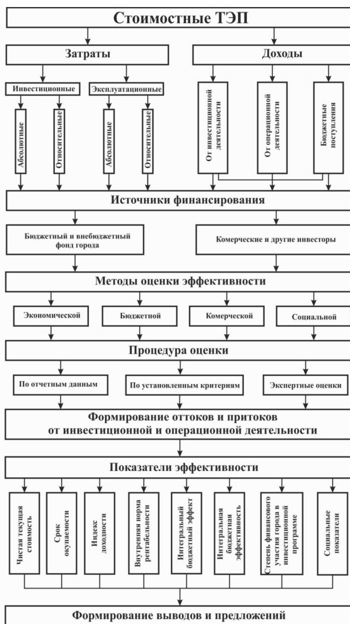
Рис. 1. Блок-схема формирования технико-экономических показателей (ТЭП), используемых при оценке эффективности инвестиционных программ по застройке территорий жилых районов
