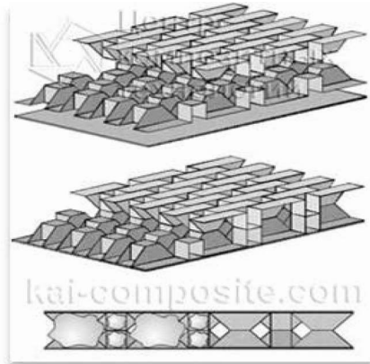
б) компоновка модулів гофрованих СК Рис.5 . Гофровані СК у літакобудуванні
