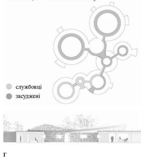
Рис. 1.2. Тюрма для психічно хворих засуджених, Берлін, Німеччина: а - розрізи по житловому та виробничому блокам; б - план комплексу
